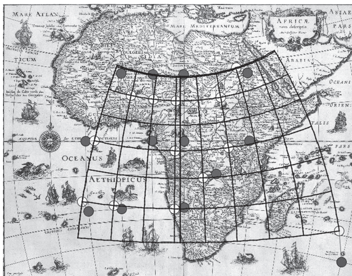
Obr. 5 – Nevhodne rozmiestnené identické body (sivé body = ručne určené, biele body = vygenerované softwarom Detectproj po analýze). Zdroj: autor.
